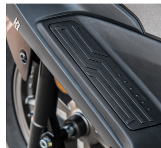
Plancher avec 2 positions pour les pieds Voetenplank met twee posities voor de voeten
